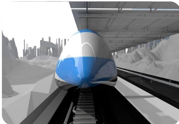
**高速飞行列车**：利用磁悬浮消除摩擦阻力，利用近真空减小空气阻力，利用直线电机提供牵引力，实现“贴地飞行”。
